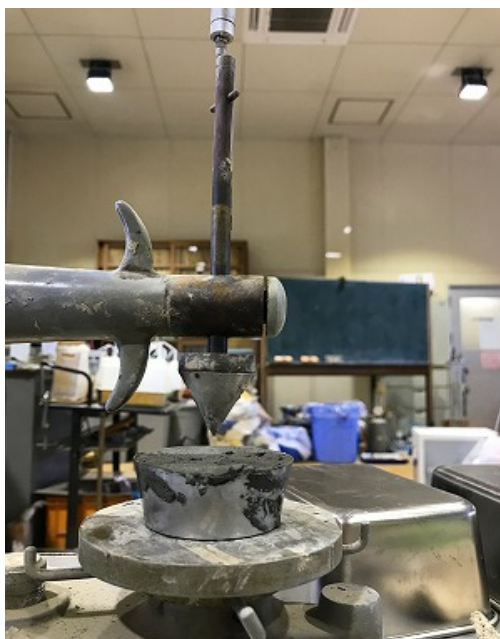
図 1. フォールコーン試験装置
