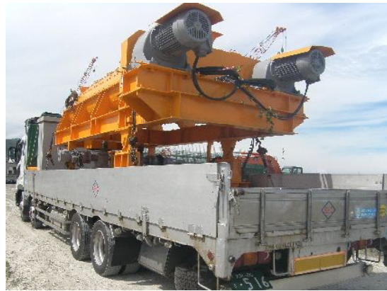
混合部(攪拌部)
