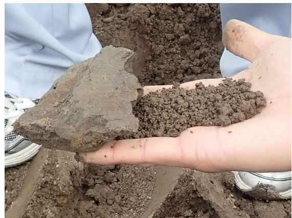
写真4 改良前(左)と改良後(右)の外観
